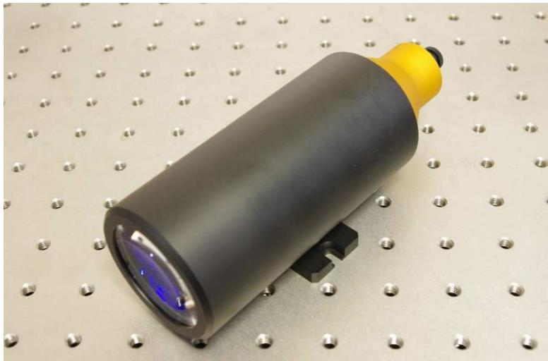
本レンズは、特にファイバ光源の光を効率良く集光でき、レンズ端面から集光位置までの作動距離も多く取れるように設計（50mm）された「0.4倍高効率集光レンズ」です。集光側のNAを0.38（F値で1.3）まで高めています。
